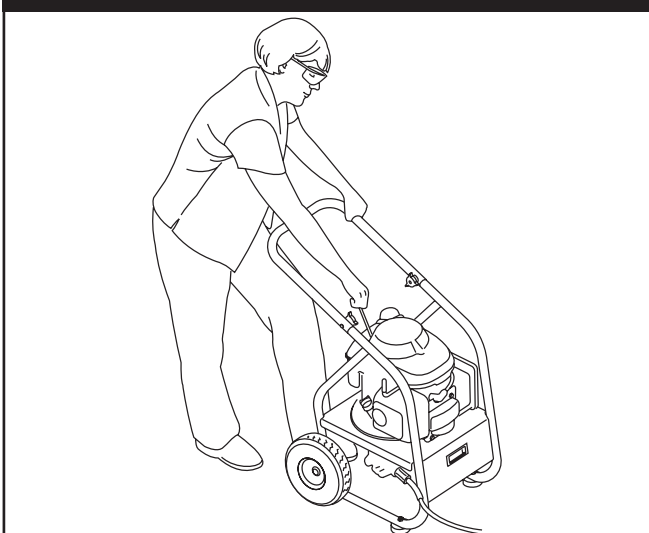
Figura 25 - Posición Recomendada para Poner en Marcha el Motor
