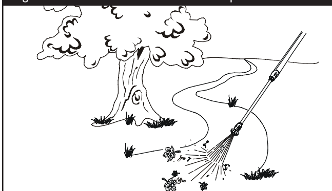
Figura 27 - Poner a Prueba el Patrón de Aspersión
