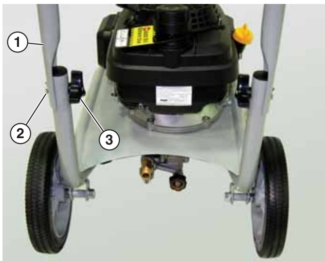
Figura 12 – Instalación de la manija superior
