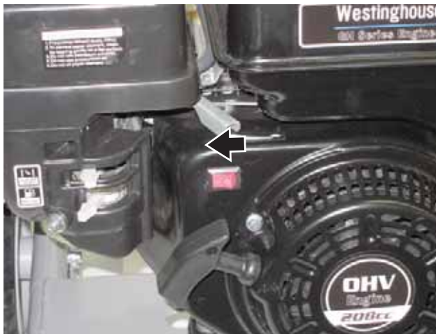
Figura 41 – Interruptor ON/OFF (Encendido/Apagado)
