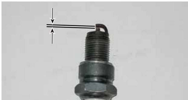
Figura 67 – Requisitos de separación de la bujía
