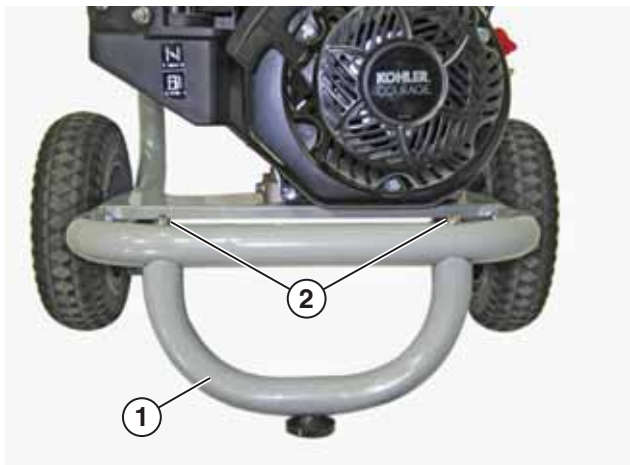
Figura 10 – Instalación del soporte delantero
