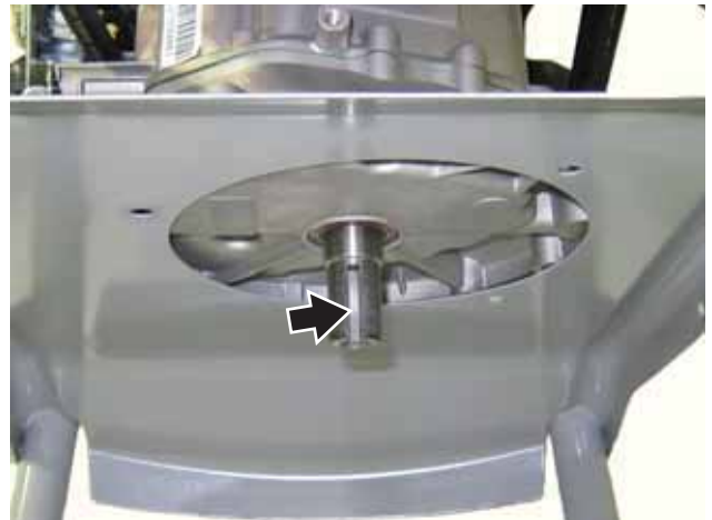
Figura 55 – Chaveta y chavetero de cigüeñal
