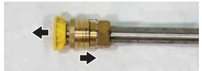
Figura 34 – Instalación de boquilla
