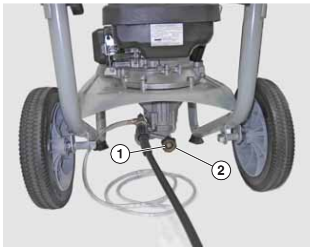
Figura 17 – Conexión de agua
