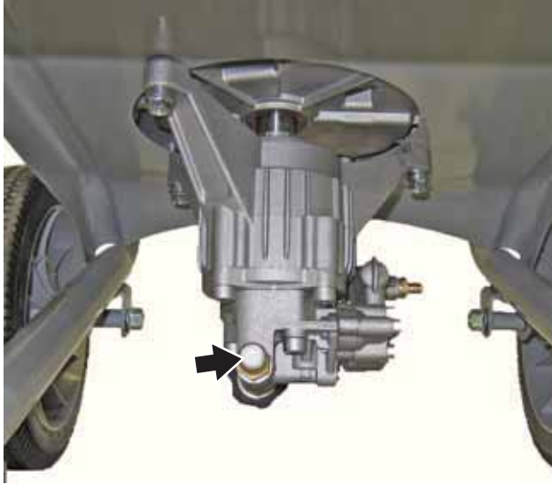
Figura 19 – Termo válvula de la bomba
