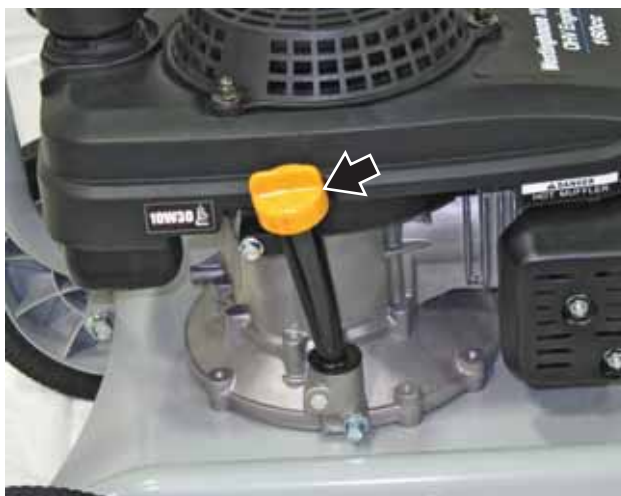
Figura 26 – Tapón de llenado/varilla de medición del aceite
