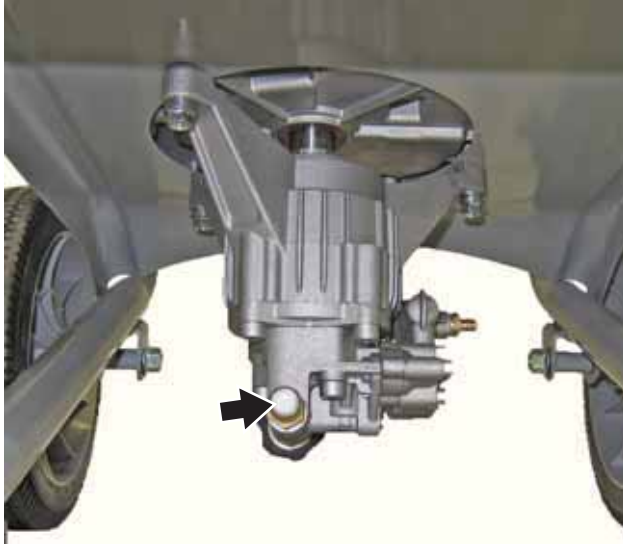
Figura 19 – Termo válvula de la bomba
