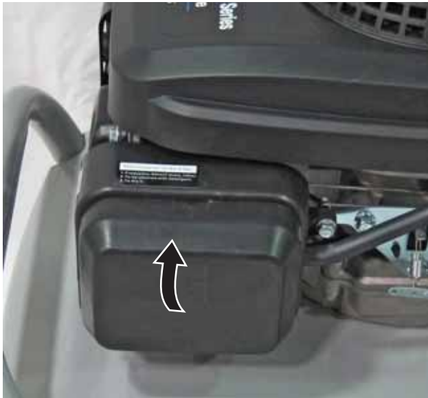
Figura 32 – Colocación de la cubierta del filtro de aire
