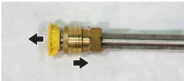
Figura 38 – Extracción de punta del atomizador
