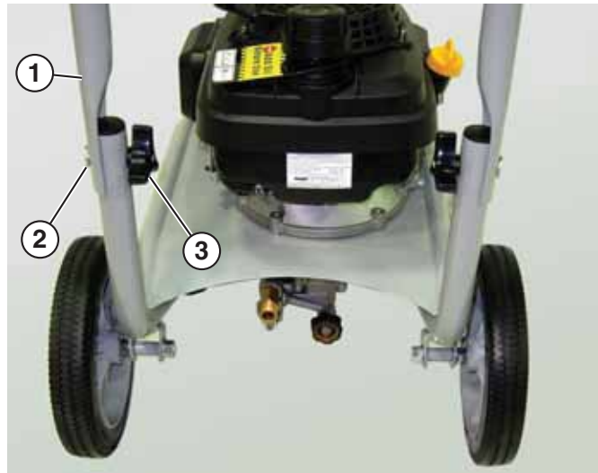
Figura 9 – Instalación de la manija superior
