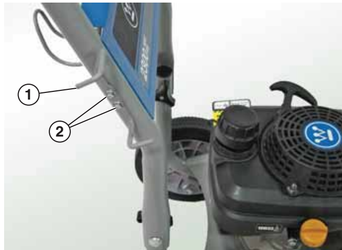
Figura 10 – Instalación del soporte de la pistola atomizadora
