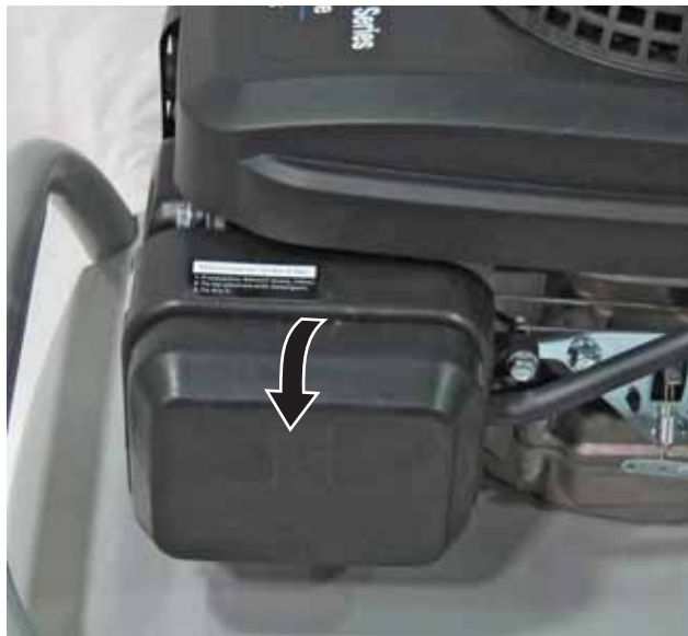
Figura 29 – Procedimiento para retirar la cubierta del filtro de aire
