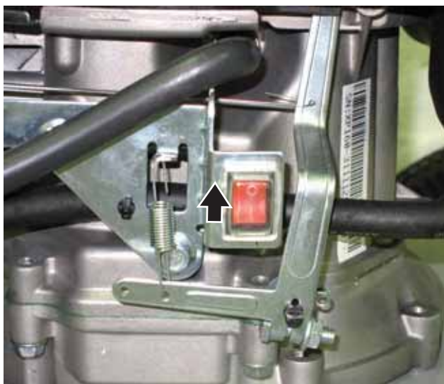
Figura 22 – Interruptor de parada del motor Posición OFF (APAGADO)
