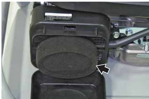
Figura 30 – Procedimiento para retirar el elemento del filtro de aire
