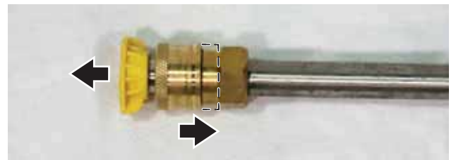
Figura 25 – Instalación de boquilla
