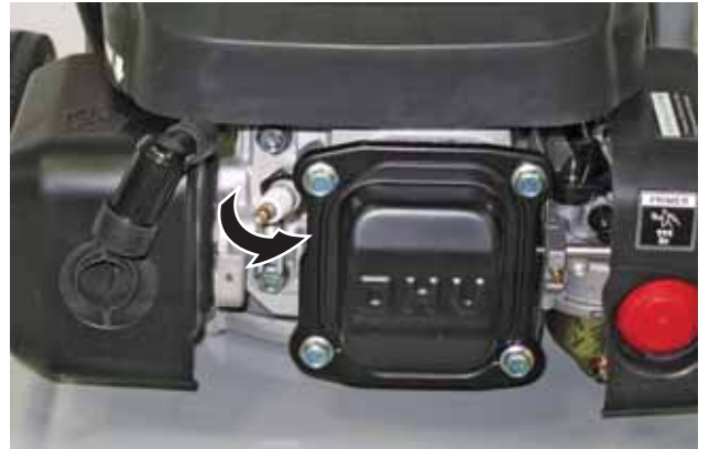
Figura 34 – Procedimiento para extraer la bujía
