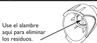
Figura 45 - Mantenimiento de la Boquilla
