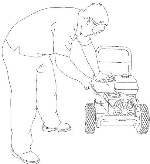
Figura 25 - Posición Recomendada para el Arranque
