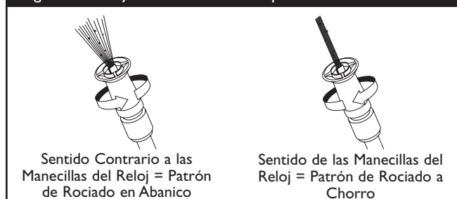
Figura 36 — Ajustar el Patrón de Aspersión
