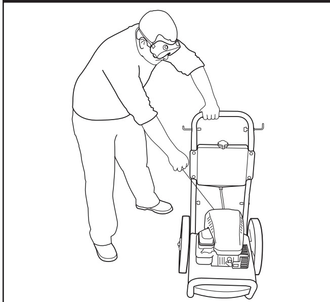
Figura 33 - Posición Recomendada para el Arranque
