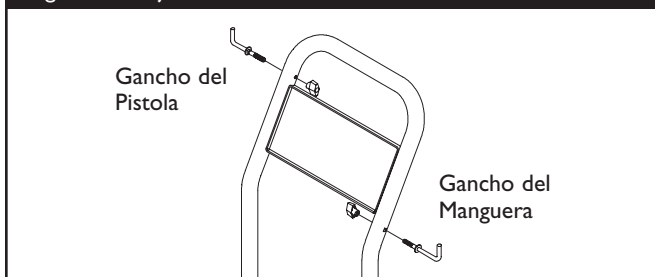
Figura 17 - Fijar el "L" Perno a la Manubrio
