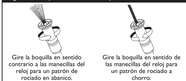
Figura 28 — Ajustar el Patrón de Aspersión
