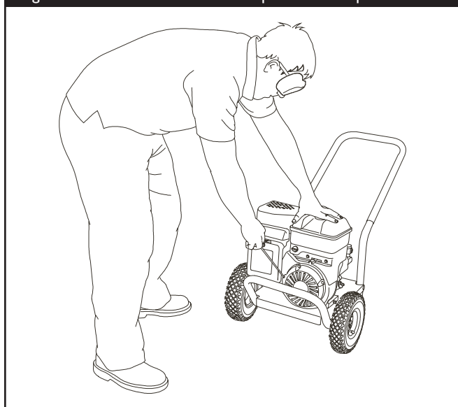
Figura 30 - Posición Recomendada para el Arranque
