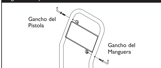
Figura 17 - Fijar el "L" Perno a la Manubrio
