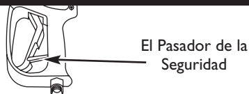
Figura 24 — La Pistola Rociadora con el Pasador de Seguridad en su Posición
