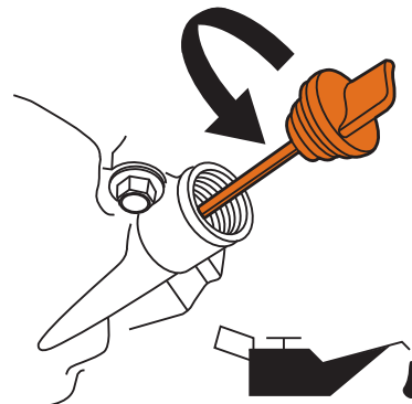
Figura 31 – Llenado de aceite del motor
