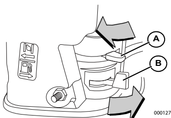
Figure 3-2. Robinet de carburant et levier d'étrangleur
