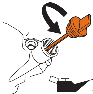
Figure 31 - Remplir l'huile à moteur
