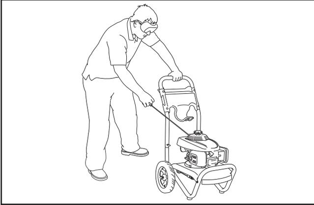
**▲ AVERTISSEMENT** Un effet de recul (rétroaction rapide) de la corde du démarreur tirera votre main et votre bras vers le moteur plus rapidement que vous ne pouvez relâcher la corde; ce qui pourrait causer des fractures, des ecchymoses ou des entorses risquant d'entraîner des blessures graves.
