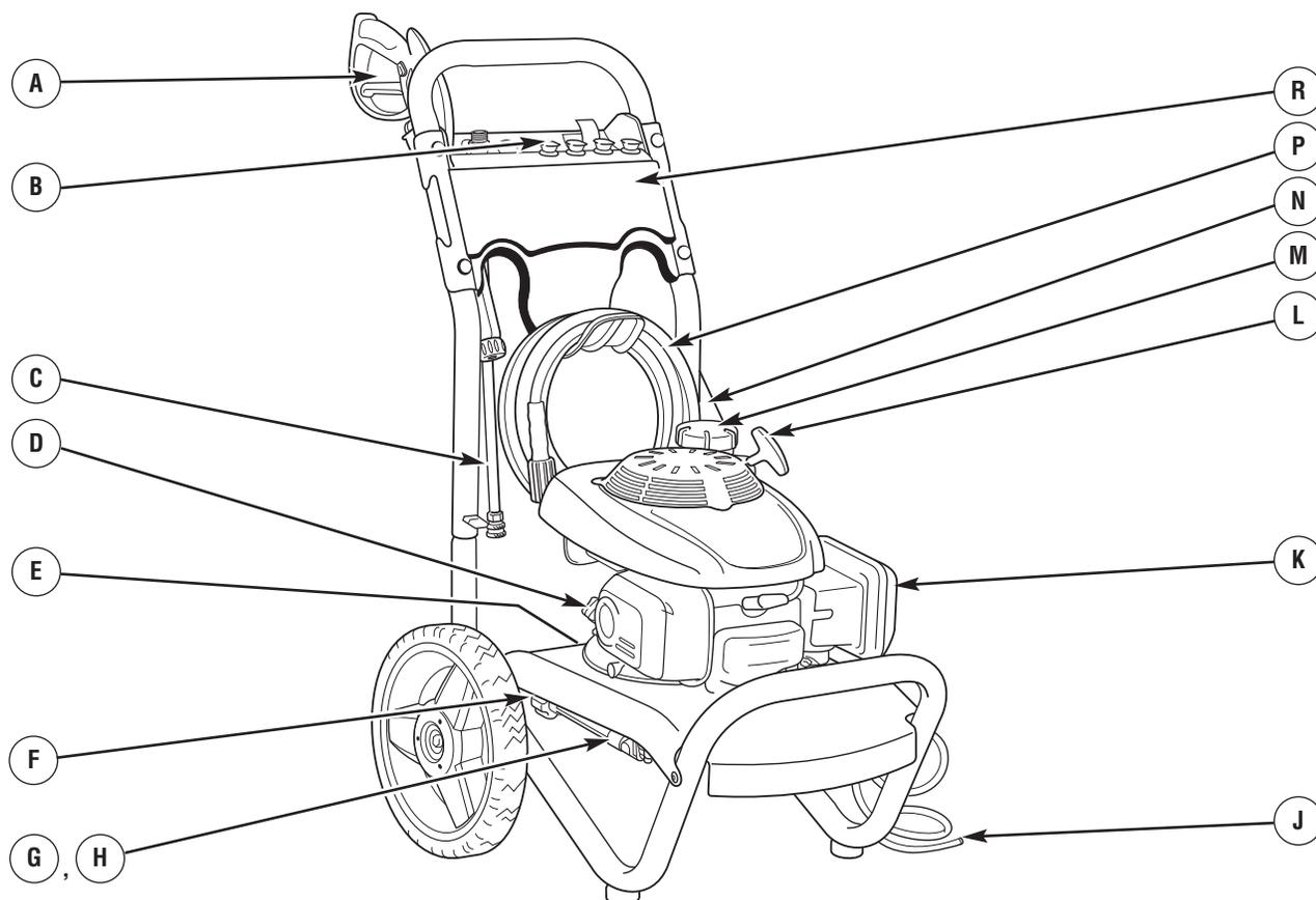
**A - Pistolet de pulvérisation** — Un dispositif de détente permet de contrôler le jet d'eau sur la surface à nettoyer. Le pistolet est muni d'un verrou de sécurité.
