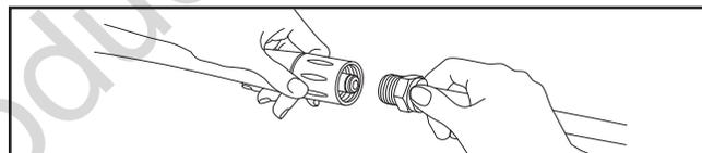
7. Choisissez la buse que vous voulez utiliser, tirez la bague de la rallonge de buse, insérez la buse, puis relâchez la bague. Vérifiez si la buse est correctement installée en tirant dessus. Consultez la section *Comment utiliser les buses*.
