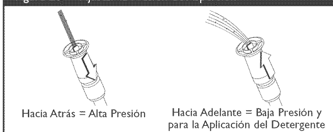
Figura 26 — Ajustar la Presión de Aspersión
