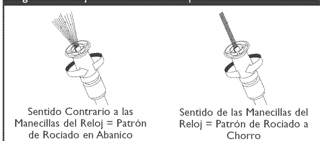
Figura 28 — Ajustar el Patrón de Aspersión
