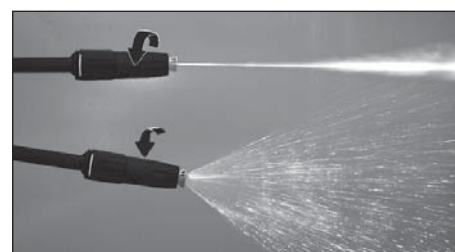
Figura 11 - Ajuste del patrón de rociado
