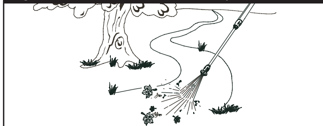
Figura 93 - Poner a Prueba el Patrón de Aspersión
