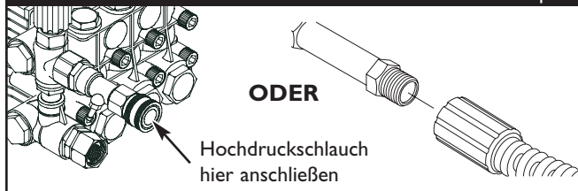
Abb. 48 - Anschließen des Hochdruckschlauchs an der Pumpe
