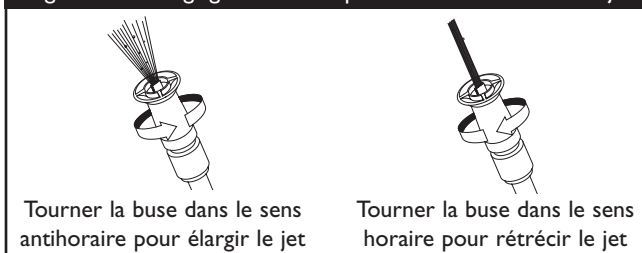
Figure 34 — Réglage de la buse pour modifier la forme du jet
