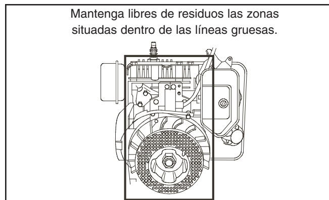
Figura 23 — Mantenga libres de residuos las zonas situadas dentro de las líneas gruesas
