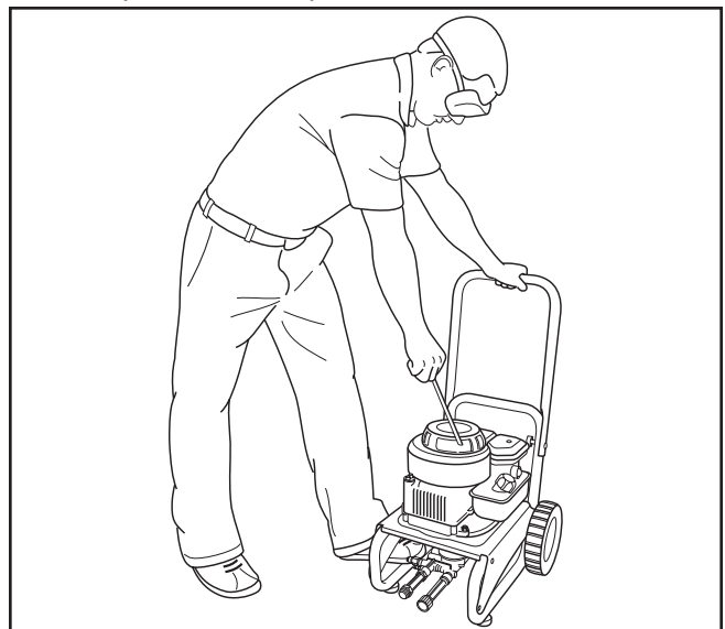
Figura 11 — Posición recomendada para el arranque
