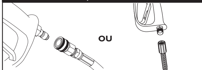
Figura 67 — Conecte a Mangueira de Alta Pressão à Pistola de Pulverização
