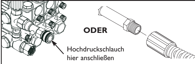
Abb. 48 - Anschließen des Hochdruckschlauchs an der Pumpe
