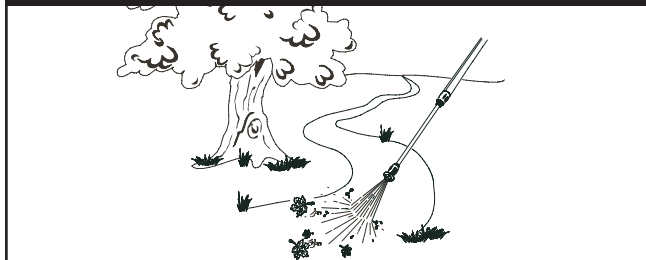
Abb. 53 - Überprüfen des Spritzmusters
