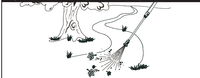
Figura 93 - Poner a Prueba el Patrón de Aspersión
