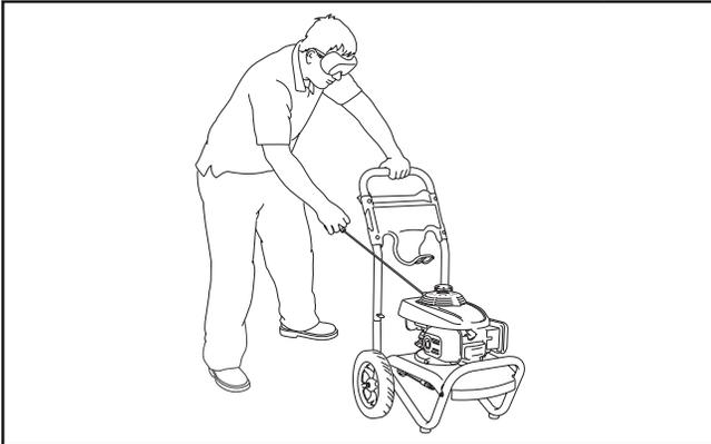
**⚠ AVERTISSEMENT** Le recul du câble de démarreur (rétractation rapide) a pour effet de tirer la main et le bras en direction du moteur plus rapidement qu'il n'est possible de le lâcher, ce qui pourrait provoquer des fêlures, fractures osseuses, des contusions ou des entorses entraînant de graves lésions.
