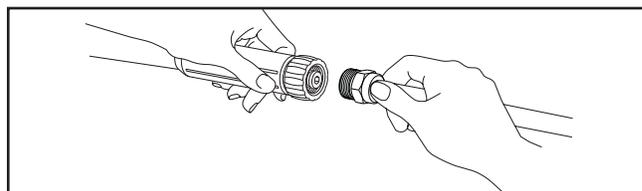
7. Choisissez la buse de pulvérisation que vous souhaitez utiliser, tirez sur le col de l'extension d'embout, insérez la buse de pulvérisation et relâchez le col. Tirez sur l'embout de pulvérisation pour s'assurer qu'il est bien en place. Consultez la section *Comment utiliser les buses de pulvérisation*.
