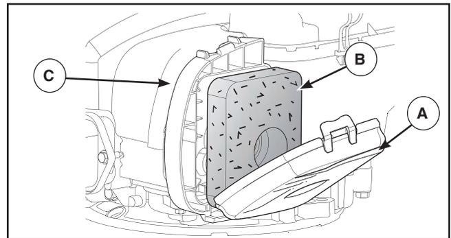
2. Enlevez l'ensemble filtre à air avec soin de manière à éviter la chute de débris dans le carburateur.
