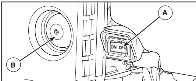
9. Appuyez 3 fois fermement sur la poire d'amorçage (B). Si le moteur est chaud, n'appuyez pas sur la poire d'amorçage.
