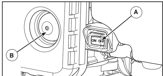
9. Press primer bulb (B) firmly 3 times. For a warm engine, DO NOT press primer bulb.
