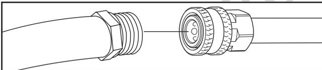
7. Réinstallez l'embout de pulvérisation dans l'extension d'embout.
