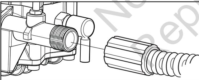
3. Avant de raccorder le tuyau d'arrosage à l'entrée d'eau, examinez la crépine d'admission (A). Nettoyez la crépine si elle contient des débris ou remplacez-la si elle est endommagée. NE mettez PAS le nettoyeur à haute pression en marche si la crépine d'admission est endommagée.
