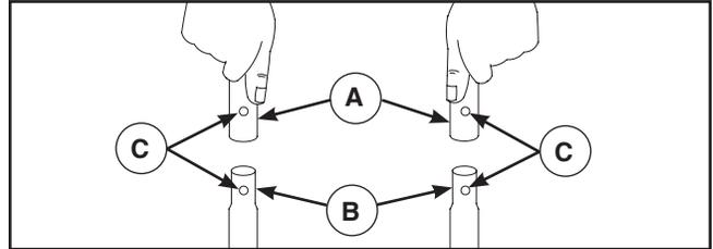
**AVIS** Il peut s'avérer nécessaire de déplacer les supports de poignée d'un côté à l'autre de manière à aligner la poignée afin qu'elle glisse sur les supports de poignée.
