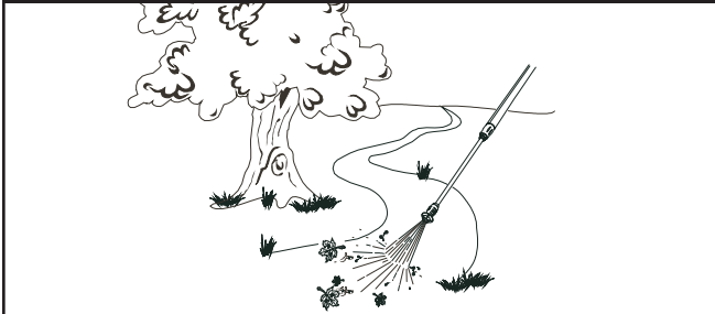
Abb. 40 - Überprüfen des Spritzmusters
