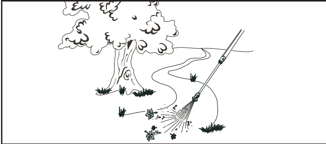
Abb. 40 - Überprüfen des Spritzmusters
