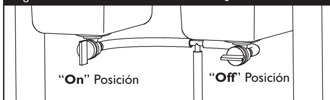
Figura 43 — Llave de Paso de Productos Químicos
