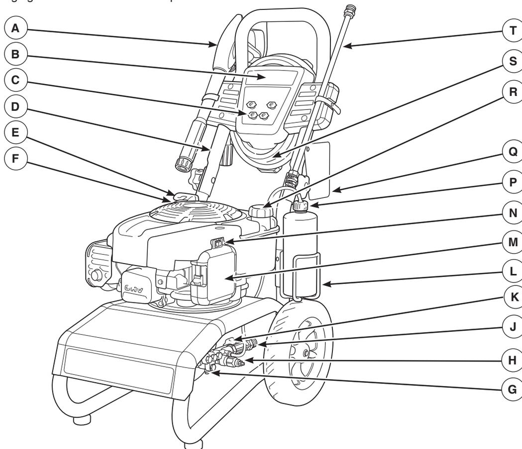
**A - Pistolet de pulvérisation** — Un dispositif de détente permet de contrôler le jet d'eau sur la surface à nettoyer. Le pistolet est muni d'un verrou de sécurité.
