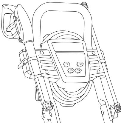
3. Placez le pistolet de pulvérisation sur la rainure se trouvant sur le plateau pour accessoires tel que montré. Tirez fermement la sangle en caoutchouc autour du pistolet de pulvérisation et placez le trou de la sangle sur la languette du plateau pour accessoires.
