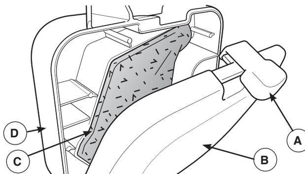
2. Enlevez filtre à air avec soin de manière à éviter la chute de débris dans le carburateur.
