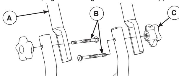
2. Insérez les boulons de carrosserie de poignée (B) dans les trous à l'intérieur de l'unité, puis fixez un bouton en plastique (C) depuis l'extérieur de l'unité. Serrez à la main.
