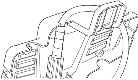
2. Placez la rallonge de buse sur la rainure se trouvant sur le plateau pour accessoires tel que montré. Tirez fermement la sangle en caoutchouc autour de la rallonge de buse et placez le trou de la sangle, sur la languette du plateau pour accessoires.
