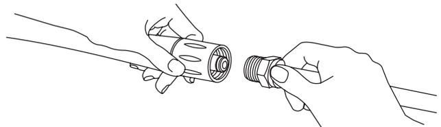
7. Choisissez la buse que vous voulez utiliser, tirez la bague de la rallonge de buse, insérez la buse, puis relâchez la bague. Vérifiez si la buse est correctement installée en tirant dessus. Consultez la section *Comment utiliser les buses*.
