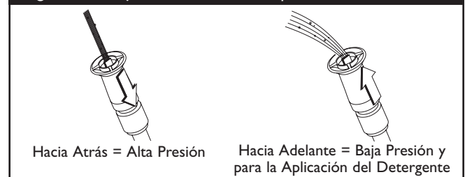
Figura 26 — Ajustar la Presión de Aspersión
