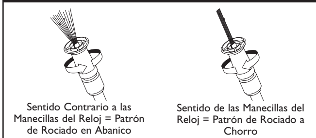
Figura 28 — Ajustar el Patrón de Aspersión
